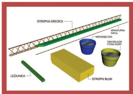
**Bijeli strop i bijeli krov** su roštiljne, lakobetonske konstrukcije debljine 15 cm i težine 130 kg/m<sup>2</sup>. Osnovu tih konstrukcija čine AB gredice i ispuna od specijalno proizvedenih Ytong blokova (stropnih ispuna).
